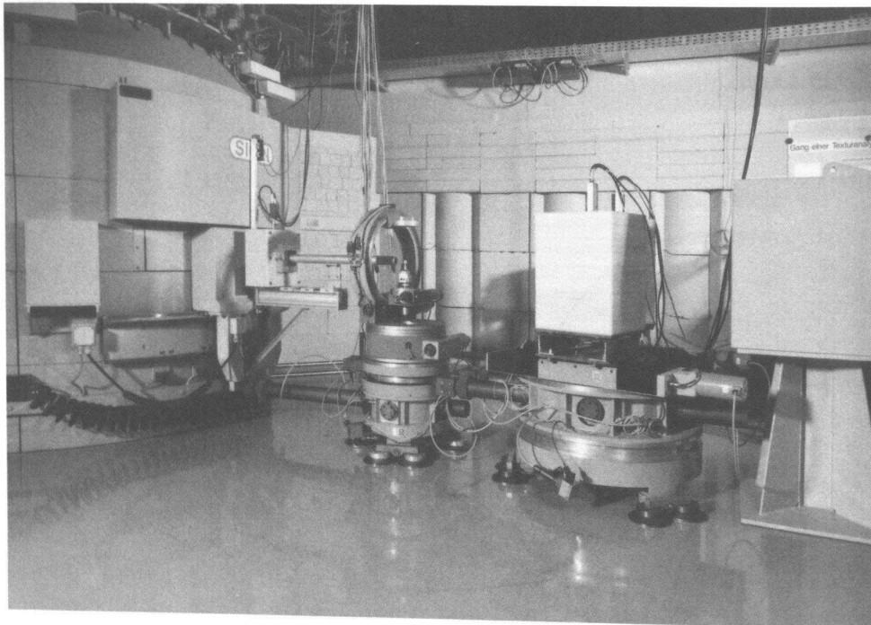
Abb.35: Das Neutronentexturdiffraktometer TEX-2 am FRG-1
