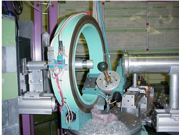
Abb. 5.11: Eulerwiege am Messplatz TEX-2 im GKSS-Forschungszentrum Geesthacht.
