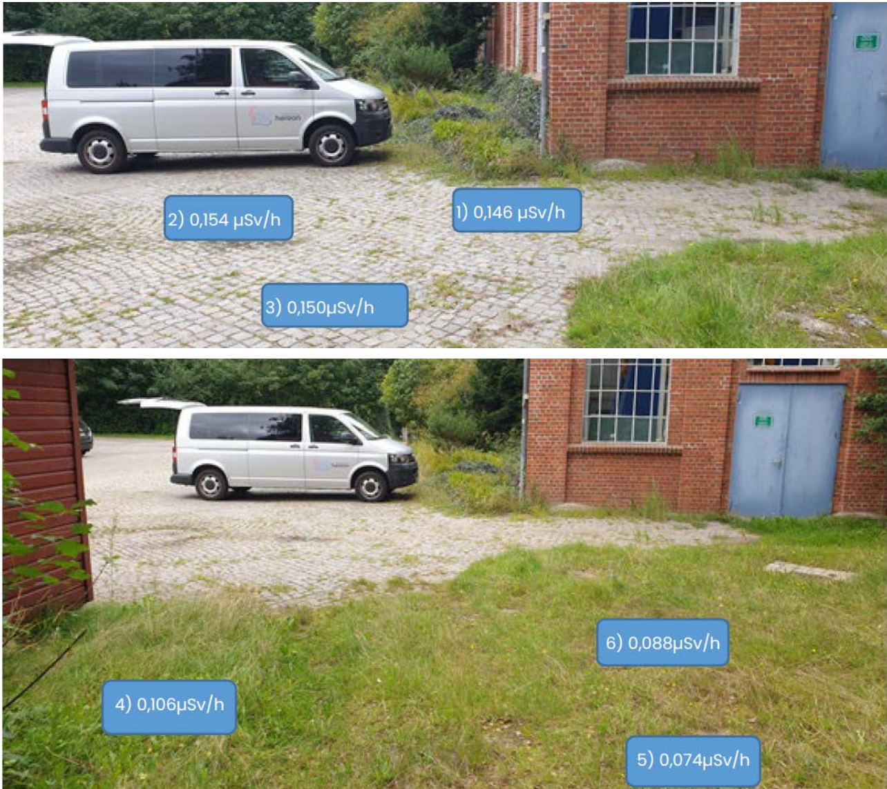
Abbildung 8-2: Zuordnung des Untergrunds der einzelnen ODL-Messung im Bereich 11.4
