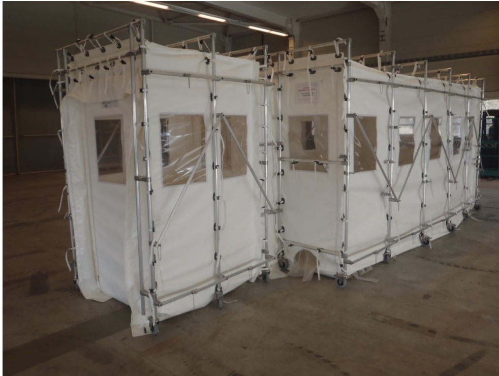
Abbildung 4-6: Mobiles Arbeits- und Dekontaminationszelt mit Zugangsschleuse
